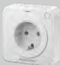
Zásuvka s rádiovým prijímačom FES 1 BS na zapnutie a vypnutie svetla a ďalších prístrojov, do 2500 Watt FES 1-1 BS na ovládanie (impulz) cudzích pohonov, ako aj na zapnutie a vypnutie svetla a ďalších spotrebičov, do 2500 W
