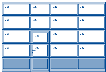
Sekcionálna brána ALR F42 s integrovanými dverami bez vysokého prahu
