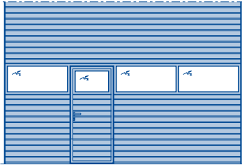
Sekcionálna brána SPU F42 s integrovanými dverami bez vysokého prahu
