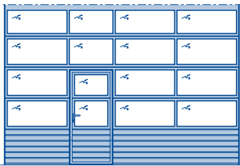
Sekcionálna brána APU F42 s integrovanými dverami bez vysokého prahu
