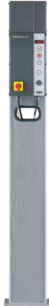
Stojaci stĺpik STI 1 na montáž max. 2 ovládaní s doplnkovou skriňou, farba: biely hliník, RAL 9006, Rozmery: 200 × 1660 × 60 mm (š × v × h)
